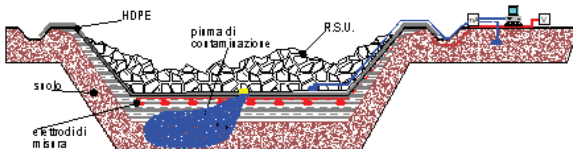
Figura 8: Schema del sistema di impermeabilizzazione e controllo geoelettrico della Discarica della Ecoserdiana Spa
